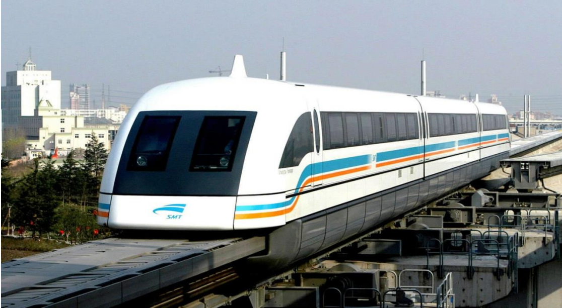
Der Maglev in Shanghai schafft bis zu 430 Stundenkilometer. Foto: Ren Long (Keystone)
